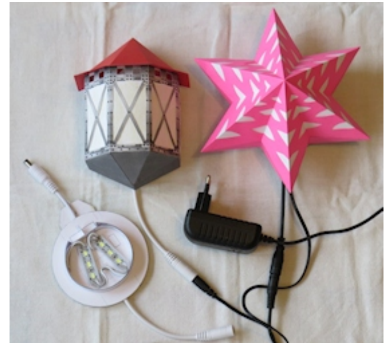
Bild3: Die Laterne und der Stern sind auf der Halterung gesteckt. Die untere Halterung wurde mit ein- und ein Ausgang gefertigt. Für den Betrieb wird hier ein kleines 12Volt Netzteil verwendet.
