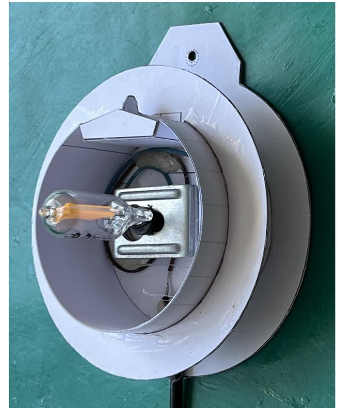
Hier wurde ein Anschlusskabel mit Buchse, ein Vorwiderstand (14 Ohm) und eine G4- Sockelhalterung eingebaut.
