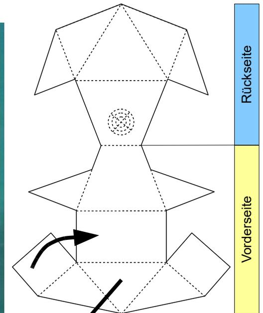
Diese Fläche wird auf die Rückseite von Teil 1 geklebt (obere Kante).
