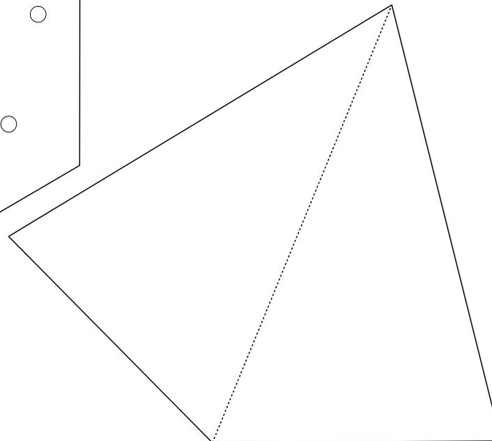
Dieses Teil bitte 6x herstellen, mit reflektierendem Material bekleben und auf die Innenseite der Seitenteile aufkleben.
