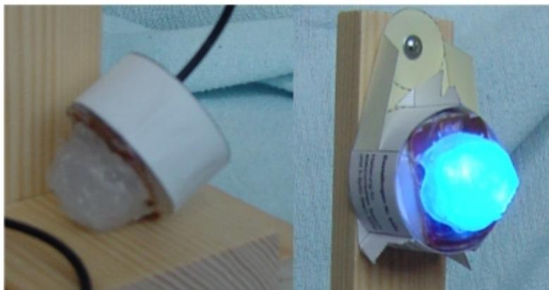
Die Leiterplatte mit den LED's wurde auf den Innenkörper verklebt (Klebepistole).
