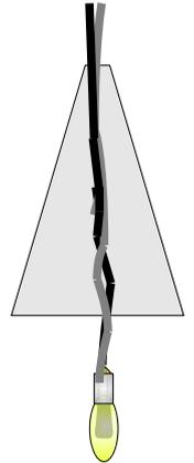
Für die Kabeldurchführung sollte ein Teil der Spitze abgeschnitten werden.
